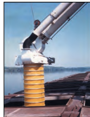
El Cardán pivotante permite diferentes ángulos de carga.
