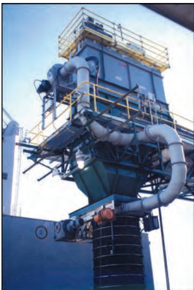
Modelo OV58 modificado w / DCL único colector de polvo intergal w / cinta transportadora headchute.
