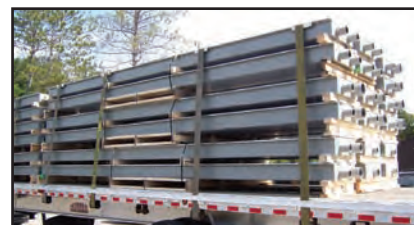
Canales de ventilación para la instalación en el piso de la bóveda.
