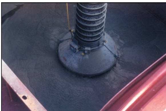
Cargando cemento aireado en barcazas Libre de polvo usando el "Estilo H de caída libre".
