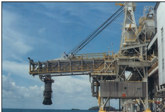
Modelo OV58 combinado con brazo y reguera telescópica para carga de Alúmina.
