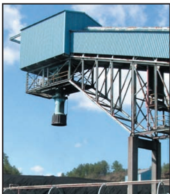
Manga de tipo Telescópico, apilando carbón.
