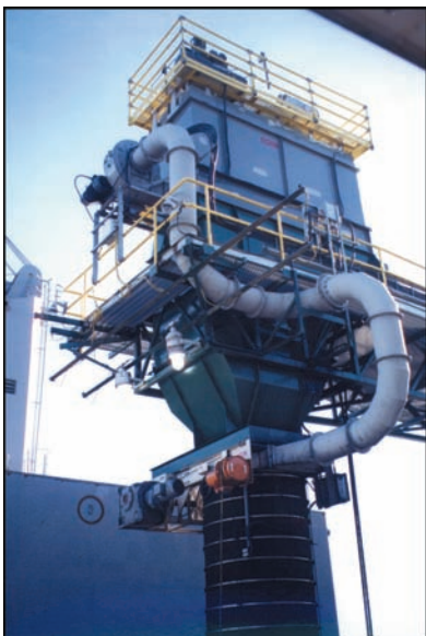
Modelo OV58 mostrado w / DCL único colector de polvo intergal w / cinta transportadora headchute.
