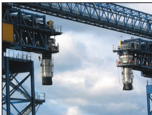
Mangas de carga para vehículos abiertos, con módulos de filtros compacto sobre un brazo oscilante.
