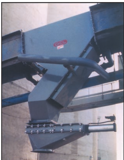
Trampa de grumos por aireación con válvula deslizante.
