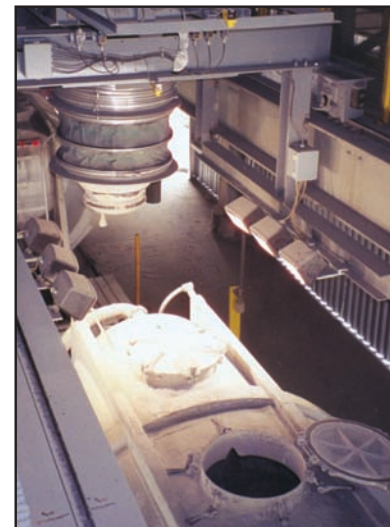
Sistema de posicionamiento de brazo articulado.
